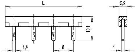
Die Verbindungsbrücke 302-J dient zum elektrischen Verbinden benachbarter Pole von Klemmen der Serie 302.
