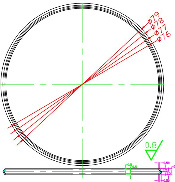
立圈：高质量气相硅胶制造，硬度60
