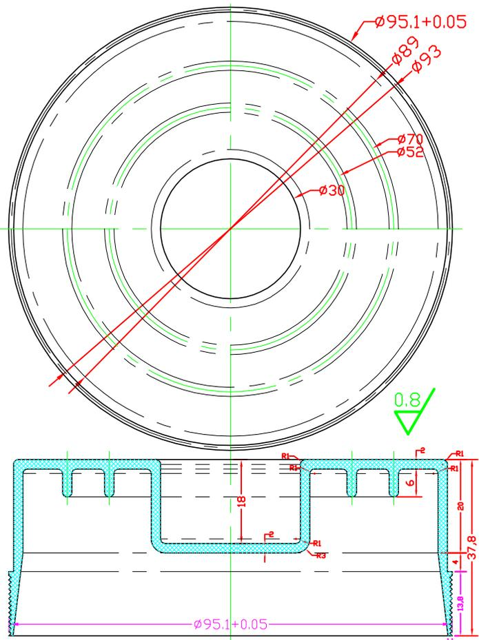
收料碗：高质量气相硅胶制造，硬度68
