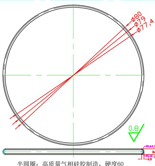
半圆圈：高质量气相硅胶制造，硬度60
