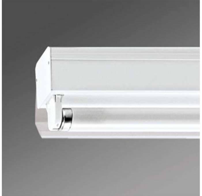
Lichtleiste; Gehäuse aus profiliertem Stahlblech, verwindungssteif; mit unverlierbaren Drehverschlüssen; die Profilierung des Oberteils bildet einen Kabelkanal für Mantelleitung bis 5 x1,5 qmm; Gehäusefarbe Verkehrsweiß RAL 9016; mit Seitenblende; Elektrischer Anschluss über 3-polige Anschlussklemme in Steckkontakt-Technik.
